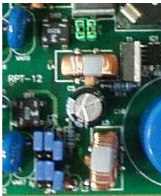
Рис 2: Номинальная установка перемычек для питания.
