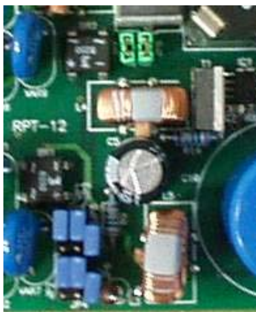
Рис.4.: Заводская установка перемычек для питания.
