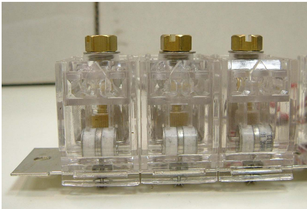
Рис. 19: защищенные в специальном желе IDC коннекторы с газовыми громоотводами - “защитный модуль”.
