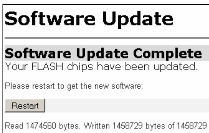
Рис. 5: Нажатие на кнопку »Restart« перезапускает систему и загружает новое программное обеспечение.
